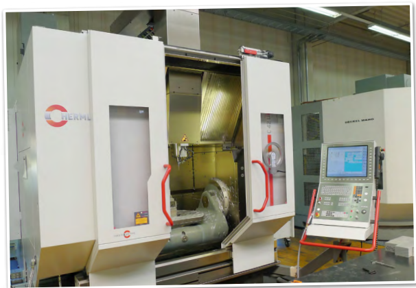
■ Das Hermle Bearbeitungszentrum C42 UI als reale Maschine in der Produktion von Gerus...
