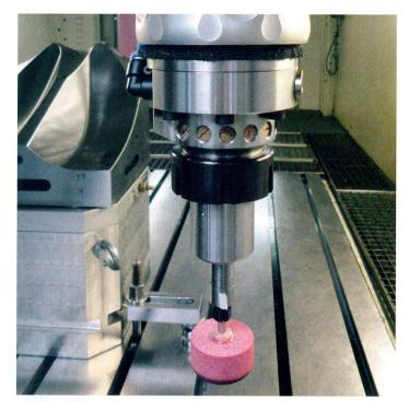
ie Experten für druckluftbetriebene Werkzeuge und Spindeln von Biax, eine Marke des schwäbischen Familienunternehmens Schmid & Wezel aus Maulbronn, haben ein modulares Druckluftspindelsystem "RSC" mit Auslenkung auf den Markt gebracht, welches das Polieren und Nachbearbeiten von Oberflächen generell verändern könnte.
