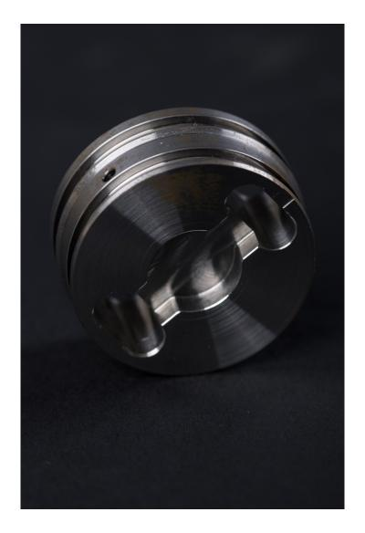
Foto 6: Ein typisches Werkstück aus der Cincom M32:
